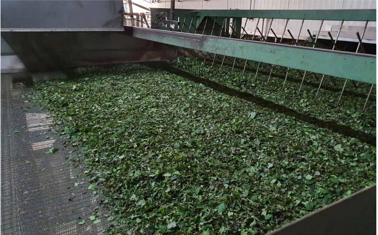
*Minze auf dem Stangengewebgurt, Typ N 600 mit glatten Querstäben*
